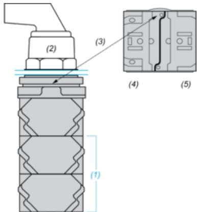
(1) Il est possible de monter jusqu'à 3 niveaux de blocs de contacts (6 blocs maximum)
