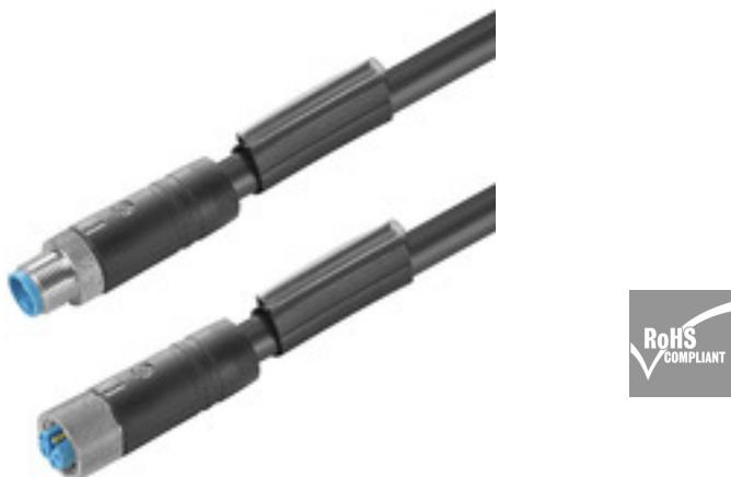
Ihre Geräte in der Peripherie sollen mit großer Leistung versorgt werden. Mit unseren neuen M12-Steckverbindern sind mehr als 250 V und 2 A problemlos möglich. Die kompakten A-, K-, L-, S- und T-codierten M12-Steckverbindern sind auf die Übertragung von bis zu 630 V AC bzw. 60 V DC und 12 A ausgelegt.
