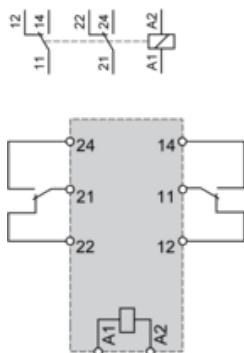
NOTE: Pour l'entrée CC, A1 doit être +, sinon court-circuit du module de protection
