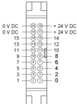
Schema di cablaggio
