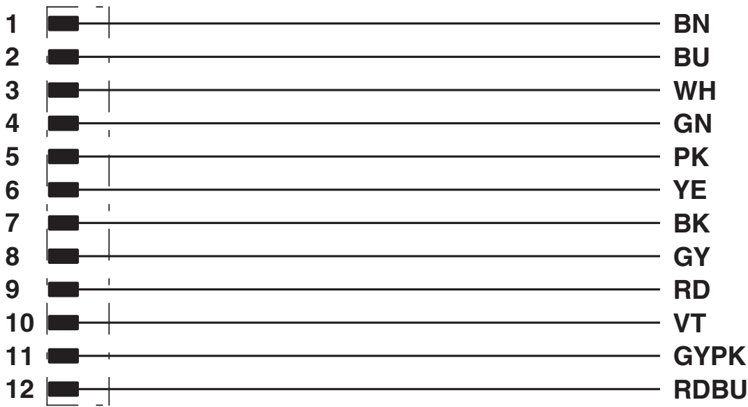
Ocupación de contactos del conector macho M12
