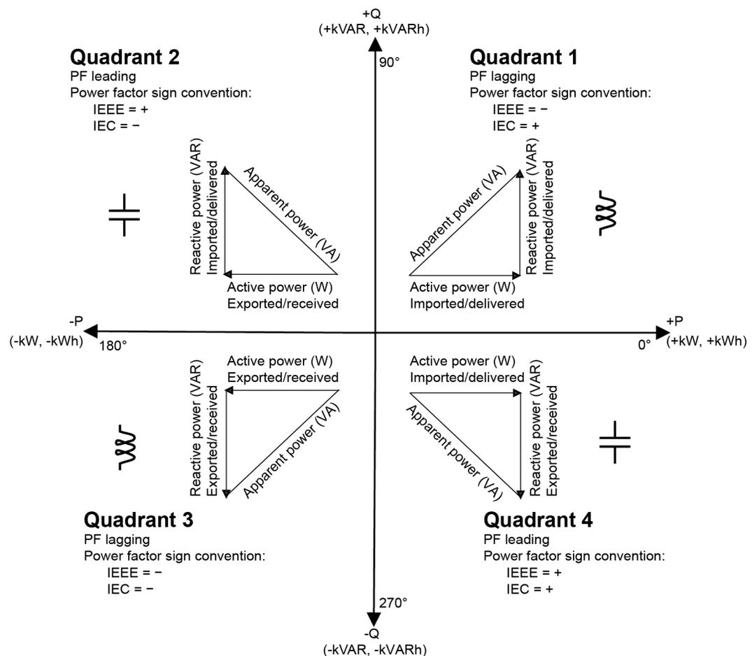
Les unités de puissance sont les watts (W ou kW) pour la puissance réelle P, les vars (VAR ou kVAR) pour la puissance réactive Q et les voltampères (VA ou kVA) pour la puissance apparente S.
