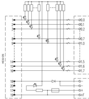
Das Schaltbild entspricht der Ausführung mit LEDs.
