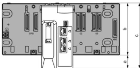
a : espace supplémentaire sous le rack pour tenir compte de la hauteur du processeur (CPU). Pour un rack X Bus : 30,9 mm (1,217 pouce); pour un rack Ethernet : 29,49 mm (1,161 pouce).
