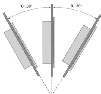
Cuando instale este producto en posición inclinada, la cara de este no debe inclinarse más de  $30^\circ$ .
