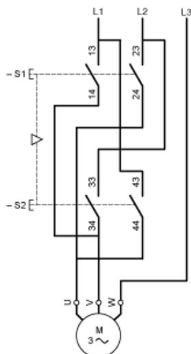
Combinado con bloque aislante de 3 polos XACS399 o XACS3991, mostrado en la posición de reposo (control remoto colgante "suministrado"), con operador de parada de emergencia con liberación con llave, acción de desencadenamiento y enclavamiento.
