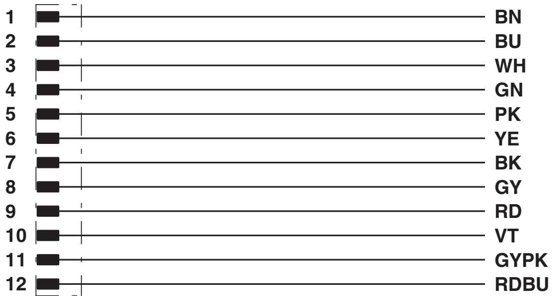
Ocupación de contactos del conector macho M12
