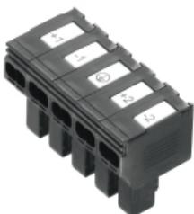
Energieverteilung mit ungeschnittener Leitung mit Leitungsquerschnitten von 1,5 bis 6mm<sup>2</sup>. Einspeisung / T-Abzweig über PUSH IN Anschluss 0,5 bis 10 mm<sup>2</sup> und/oder Steckanschluss 0,5 bis 4mm<sup>2</sup>. Farbige Markierungen ermöglichen eine eindeutige Leiterzuordnung.
