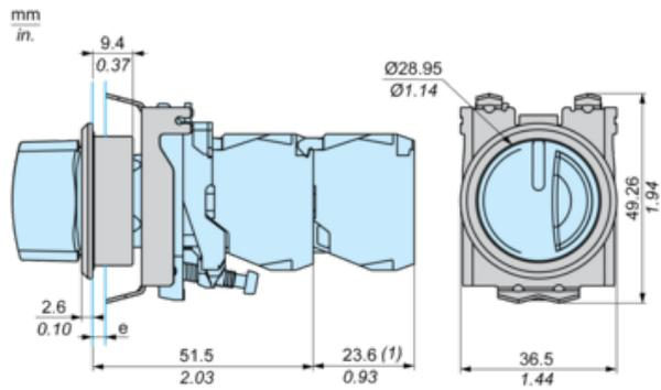
e: Espesor de sujeción: de 1.2 a 2.8 mm (de 0.05 a 0.11 in)
