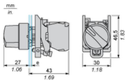
e: espesor de sujeción: de 1 a 6 mm (de 0.04 a 0.24 in)
