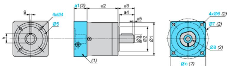
(1) Kit adattatore servomotore
