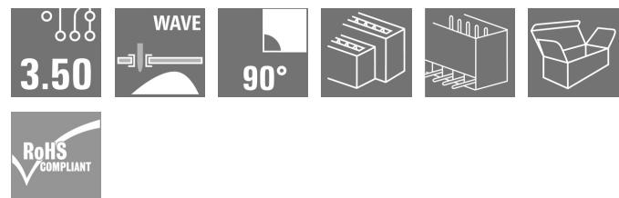
Doppelstöckige, versetzt angeordnete Stifteleiste für Wellenlötverfahren im Raster 3,50 mm. Die Stifteleiste steht in geschlossener und Flanschversion zur Verfügung. Die Stifteleisten bieten Platz für Beschriftungen und können kodierte werden.
