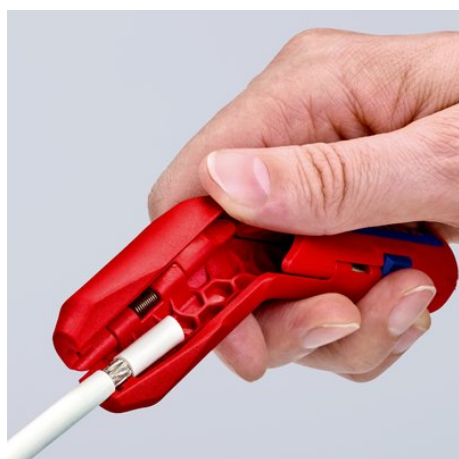
Pelar la cubierta exterior de un cable coaxial
