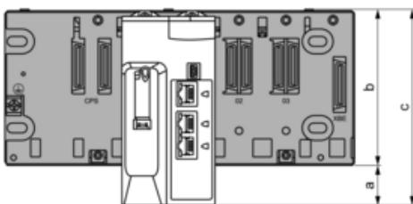
a : espace supplémentaire sous le rack pour tenir compte de la hauteur du processeur (CPU). Pour un rack X Bus : 30,9 mm (1,217 pouces); pour un rack Ethernet : 29,49 mm (1,161 pouces).
