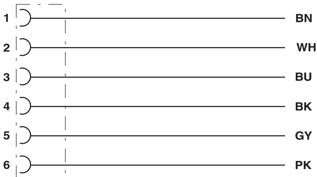
Affectation des contacts du connecteur femelle M8
