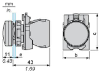
e : épaisseur du dispositif de serrage : 1 à 6 mm / 0,04 à 0,24 pouce
