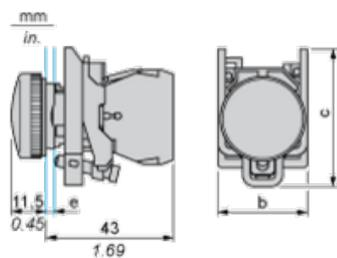
e: spessore fissaggio: da 1 a 6 mm / da 0,04 a 0,24 in.
