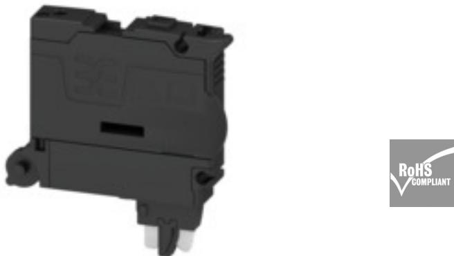
Der Sicherungshalter SIHA macht im Handumdrehen aus einer Trennklemme eine Sicherungsklemme: Einfach den Trennhebel entfernen und den Sicherungsstecker aufstecken.
