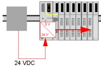
Die folgende Abbildung zeigt, wie das 24-VDC-Signal an ein Erweiterungssegment auf dem Island verteilt wird:
