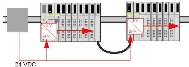
Das logische Spannungssignal endet im STB XBE 1100-Modul am Segmentende (EOS).
