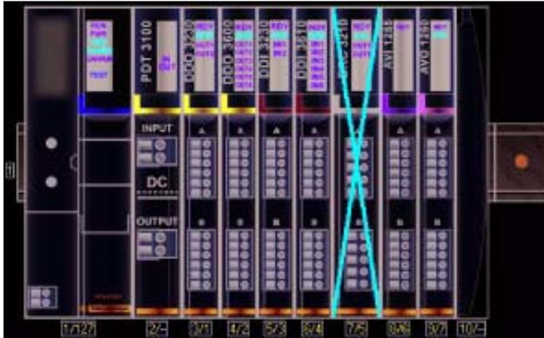
Wenn Sie beispielsweise physikalisch die oben beschriebene Konfiguration errichten, so würden Sie das Island ohne das Modul DRC-3210 und dessen Grundträger errichten.
