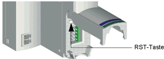
Durch Drücken und gedrückt halten der RST-Taste für mehr als zwei Sekunden wird der Inhalt des Flash-Speichers überschrieben, was zu einer neuen Konfiguration für das Island führt.
