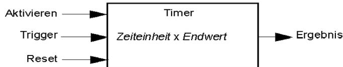
Der Triggereingang für den Timer startet den Timer bei 0 und akkumuliert *Zeiteinheiten* von 1, 10, 100 oder 1000 ms für eine festgelegte Anzahl von Zählschritten. Der Reset-Eingang bewirkt, dass der Timer auf 0 zurückgesetzt wird.
