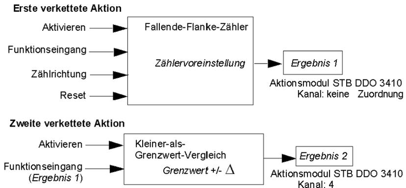
*Ergebnis 2* (vom Vergleichsbaustein) ist das Ergebnis, das die verkettete Reflex Action an einen tatsächlichen Ausgang sendet. Da das Ergebnis eines Vergleichsbausteins einem digitalen Action-Modul zugewiesen werden muss, wird das *Ergebnis 2* dem Kanal 4 eines digitalen STB DDO 3410 Ausgangsmodul zugewiesen.
