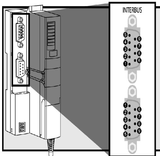
Es wird empfohlen, 9-polige SUB-D-Steckverbinder zu verwenden, die der Norm INTERBUS Club oder einer entsprechenden internationalen Norm entsprechen.
