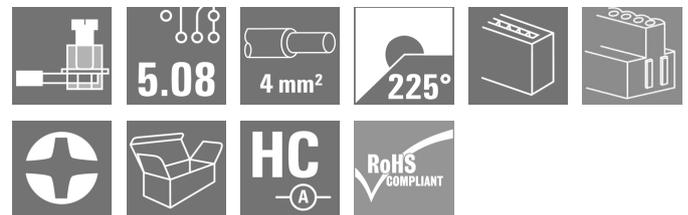
Zugbügeltechnik für Leiteranschluss mit rechtwinkliger oder schräger (90° bzw. 270° oder 225°) Abgangsrichtung. Die Buchsenstecker bieten Platz für Beschriftungen und können kodiert werden. Befestigung mittels Flansch oder Löseriegel möglich. Sie bieten zusätzlich integrierte Plus/Minus- Schraube, Leiteruntersteckschutz und werden mit geöffnetem Zugbügel geliefert. HC = High Current.
