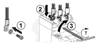
**HINWEIS:** Es können auch zwei Kabelschuhe für die Netzanschlüsse installiert werden.
