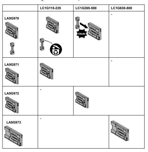
**HINWEIS:** Die mechanische Verriegelung LA9G971 und LA9G972 zwischen Stern- und Dreieckschützen unterschiedlicher Größe muss nicht angepasst zu werden.
