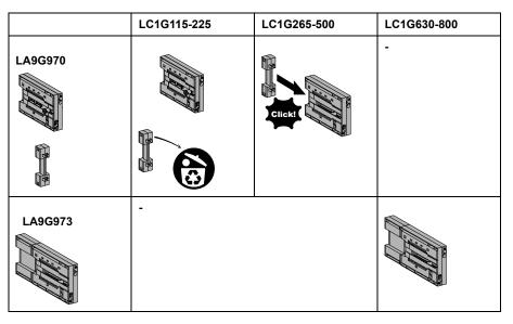
7. Setzen Sie die mechanische Verriegelung zwischen den beiden Schützen auf den Metallschienen ein.
