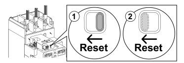
Nach dem Zurücksetzen und nach dem Einschalten von A1-A2 befindet sich das Schütz 10 Sekunden lang in der Reset-Sequenz: Die Diagnose-LED blinkt und das Schütz bleibt geöffnet. Es schließt nach den 10 s.
