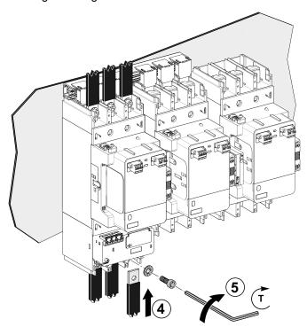
6. Platzieren Sie die Stern-Dreieck-Verbindungsschiene neben den nachgeschalteten Leistungsklemmen der Stern- und Dreieckschütze.
