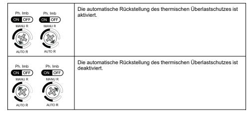
Wenn die automatische Rückstellung aktiviert ist, wird die Auslösung der thermischen Überlast automatisch in 2±1 Minuten zurückgesetzt.
