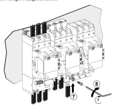
9. Platzieren Sie die Stern-Verbindungsschiene neben den vorgeschalteten Leistungsklemmen des Sternschützes.
