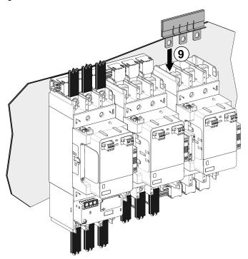
10. Setzen Sie die Schrauben und Unterlegscheiben durch die Verbindungsschienen und Leistungsklemmen ein. Ziehen Sie die Schrauben mit dem richtigen Anzugsmoment an.
