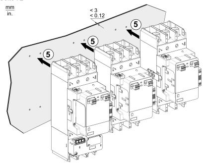
6. Montieren Sie die mechanische Verriegelung LA9G970 zwischen Stern- und Dreieckschützen der gleichen Größe entsprechend der Größe der Schütze.
