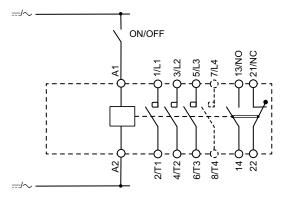
**Dreileitermodus**: Die Befehle sind vom Typ "Impuls". Es sind ein NO-Hilfskontakt und zwei Befehlskomponenten erforderlich.
