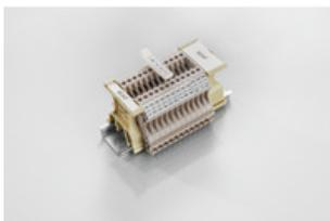
Der Gruppenschildträger SchT 5 S wird direkt auf die Tragschiene TS 32 (G-Schiene) bzw. die Tragschiene TS 35 (Hutschiene) aufgerastet. Unabhängig von Klemme und Klemmentyp kann so die Klemmleistenkennzeichnung vorgenommen werden. SchT 5 und SchT 5 S werden mit ESO 5, STR 5 Schutzstreifen bestückt.
