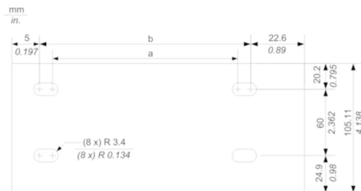
NOTE: Vous pouvez utiliser des vis M4, M5, M6 ou UNC n° 6 dans les trous de fixation.
