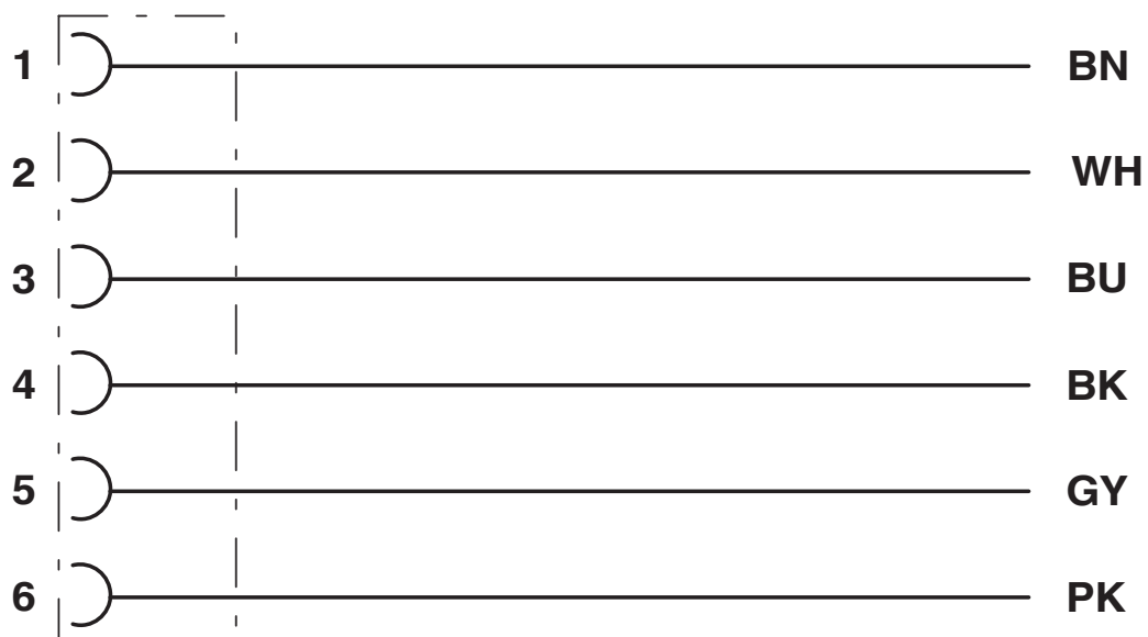
Affectation des contacts du connecteur femelle M8
