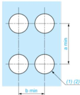
(1) Diamètre sur support ou panneau réalisé
