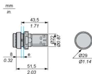
e Grosor del panel de soporte: de 1 a 6 mm (de 0,4 a 0,24 in) (metal), de 2 a 6 mm (de 0,8 a 0,24 in) (plástico).
