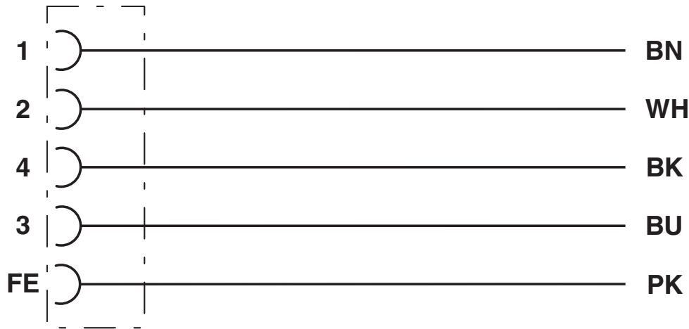
Affectation des contacts du connecteur femelle M12
