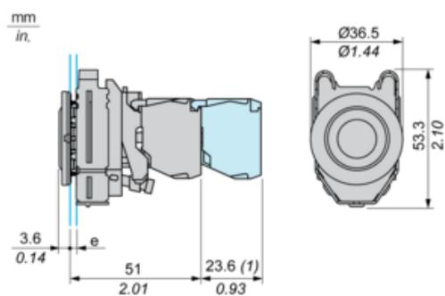
e : épaisseur du dispositif de serrage : 1 à 6 mm / 0,04 à 0,24 po.
