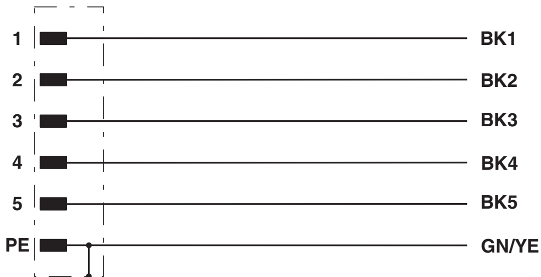
Kontaktbelegung des M12-Steckers
