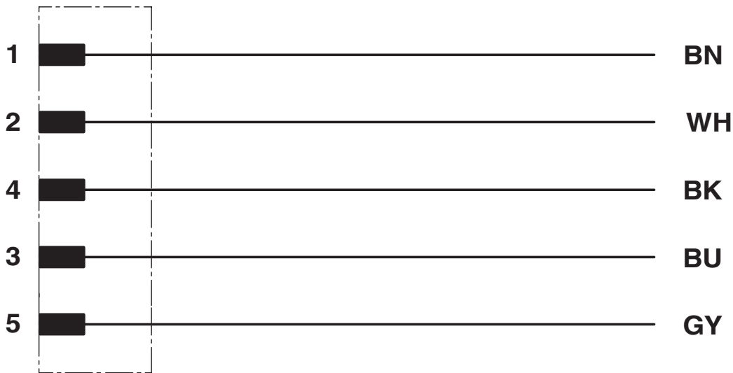
Ocupación de contactos del conector macho M12
