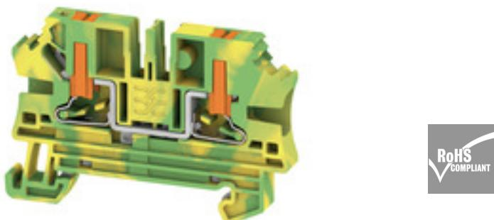
Eine schützende Durchgangsreihenklemme verbindet für Sicherheitszwecke eingesetzte elektrische Leiter und wird in vielen Anwendungen benötigt. Die elektrische und mechanische Verbindung zwischen Kupferleitern und der Befestigungsauflage wird mithilfe von Schutzleiterreihenklemmen hergestellt. Sie verfügen über ein oder mehrere Klemmstellen für die Verbindung mit und/oder Abzweigung von Schutzleitern.
