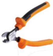
Schneidwerkzeuge für Leiter bis 8 mm, 12 mm, 14 mm bzw. 22 mm Außendurchmesser. Die spezielle Schneidengeometrie ermöglicht ein quetschfreies Schneiden von Kupfer- und Aluminiumleitern mit minimalen Handkräften. Zudem besitzen die Schneidwerkzeuge (KT 8 bis KT 22) VDE- und GS-geprüfte Schutzisolationen bis 1.000 V gemäß EN/IEC 60900.
