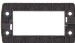
Der aus einem Stück gefertigte, einheitliche Rahmen ist schnell und einfach zu montieren und besteht aus formstabilem, glasfaserverstärktem Kunststoff. Die unverlierbare eingeschäumte Dichtung garantiert eine hohe Dichtigkeit von IP66 nach DIN EN 60529, auch an lackierten und rauen Oberflächen.
