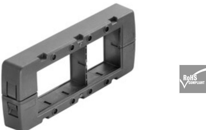
Der aus einem Stück gefertigte, einteilige Rahmen ist schnell und einfach zu montieren und besteht aus formstabilem, glasfaserverstärktem Kunststoff. Die unverlierbare eingeschäumte Dichtung garantiert eine hohe Dichtheit von IP66 nach DIN EN 60529, auch an lackierten und rauen Oberflächen.
