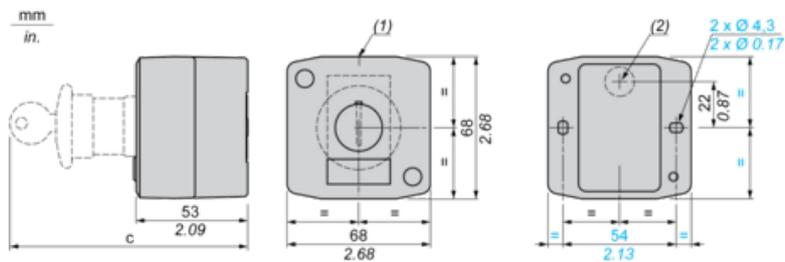
(1) 2 prerrecortes para prensaestopas Pg 13.5, capacidad máxima 12 mm (0.47 in)
