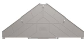
Eine Trennwand wird zur optischen Trennung von Stromkreisen oder zur elektrischen Trennung bei benachbarten Querverbindungen genutzt. Die Kontur kann im Gegensatz zur Abschlussplatte größer als die benachbarten Reihenklemmen sein. Kleiner sollte Sie jedoch nicht sein, da ansonsten die geforderten Luft- und Kriechstrecken innerhalb der Applikation nicht mehr eingehalten werden.
