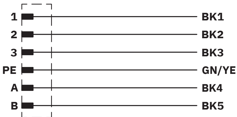
Asignación de contactos del conector hembra S15
