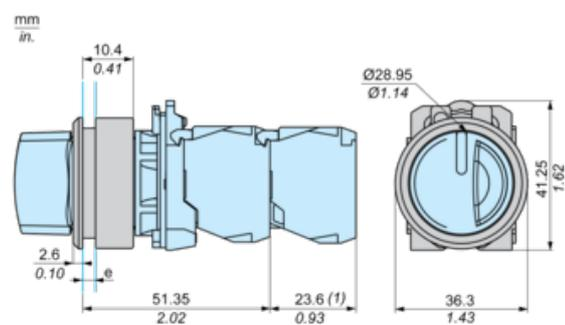
e: Espesor de sujeción: de 1 a 3,5 mm (de 0.04 a 0.14 in)
