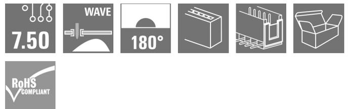
Stiftleisten mit gerader 180° Abgangsrichtung. Die Lötstiftlänge ist für Wellenlötanwendungen optimiert. Die Stiftleisten bieten Platz für Beschriftungen und können kodiert werden.
