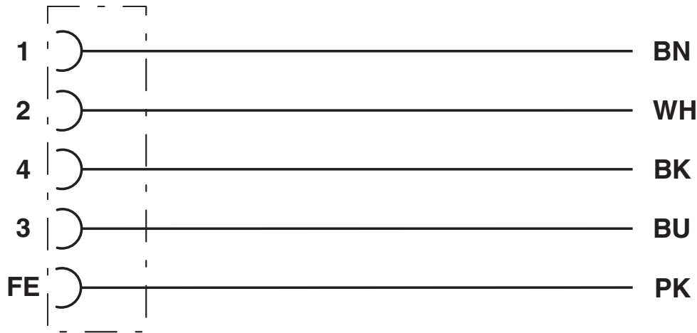
Affectation des contacts du connecteur femelle M12
