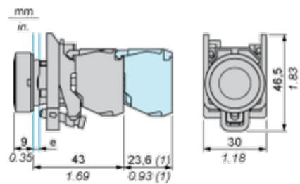
e: spessore fissaggio: da 1 a 6 mm / da 0,04 a 0,24 in.
