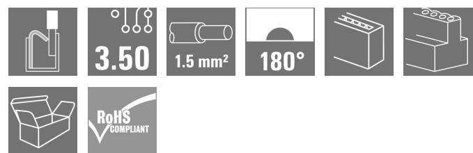
Effizient verbinden auf kleinem Raum: Buchsenstecker mit Federanschluss (Push In) als steckbare Anschlussebene, der Einsatz erfolgt in Verbindung mit den Stifteleisten im Raster 3,50 mm.
