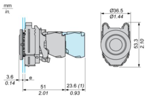
e: spessore fissaggio: da 1 a 6 mm / da 0.04 a 0.24 in.
