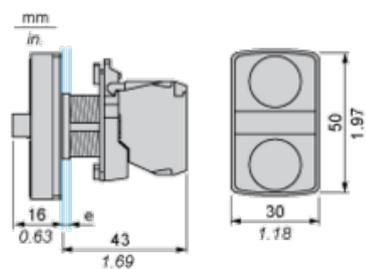
e: espesor de sujeción: de 1 a 6 mm (de 0.04 a 0.24 in)
