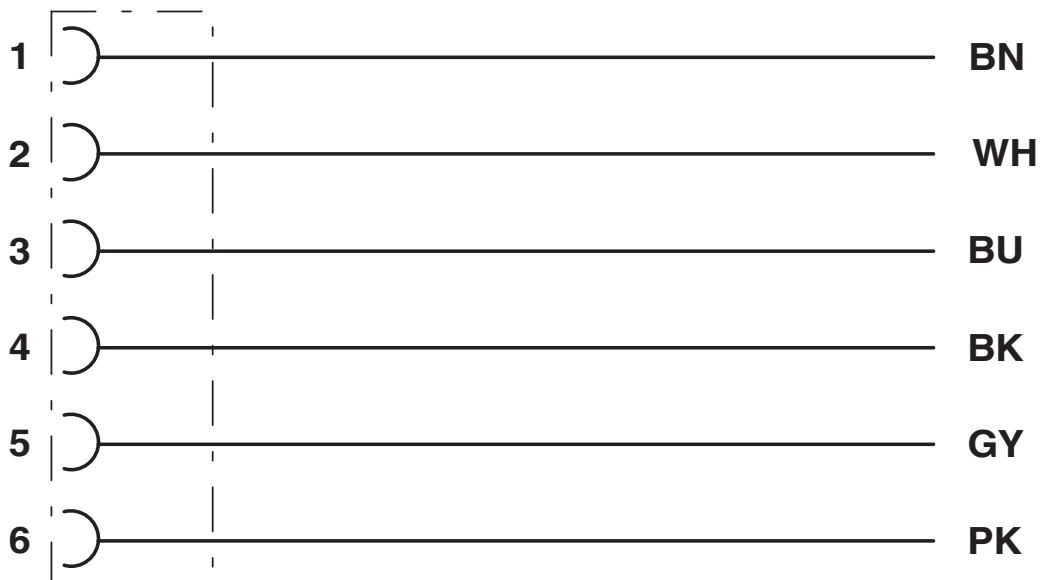
Ocupación de contactos del conector hembra M8
