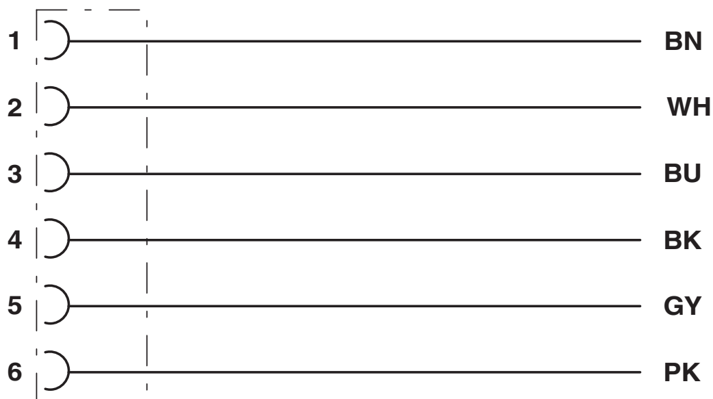
Affectation des contacts du connecteur femelle M8
