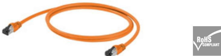
Konfektionierte Leitungen mit 2x RJ45, geeignet für Smart Metering Anwendungen, verschiedene Farben in Übereinstimmung mit DIN VDE 0603-100. Kurze Stecker und Kabel mit kleinem Biegeradius für enge Platzverhältnisse, Steckergehäuse mit umlaufender Isolation ermöglichen Schutzart IP30 im gesteckten Zustand.
